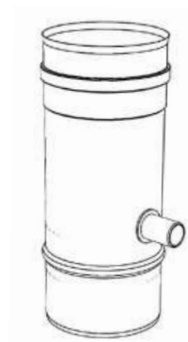
Figura 3.8, Módulo recto 250mm con desagüe lateral (15D)
