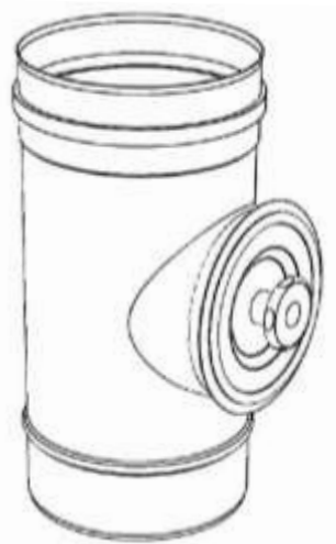
Figura 3.11, Módulo de inspección con puerta (68, 549) El aspecto exterior es el mismo en los dos.
