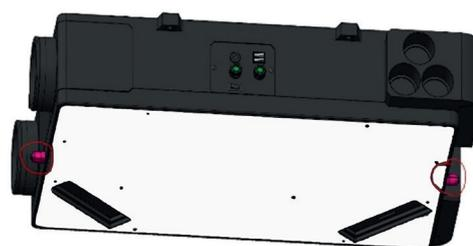
A) Corte el borde de la salida de condensación y elimine las rebabas.
