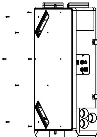
**4** Retirar la tapa exterior y el polipropileno frontal de la Unidad, dejando el interior al descubierto
