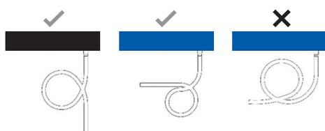
D) Llene el sifón con agua, conecte la manguera a la salida de la unidad y asegúrela con una correa.
