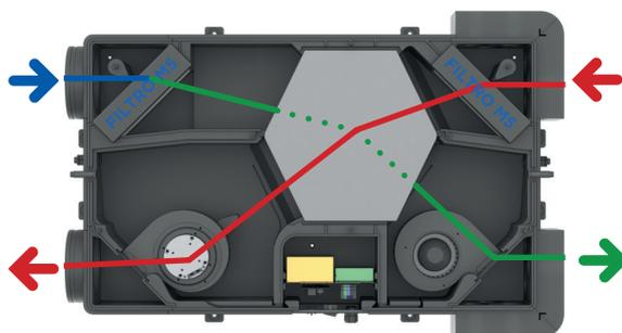
La temperatura del aire que proviene del exterior puede estar comprendida entre -20°C y +50°C, si ésta es inferior a -20°C la unidad puede apagarse automáticamente para protegerla de posibles daños.
