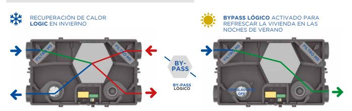
La temperatura del aire que proviene del exterior puede estar comprendida entre -20°C y +50°C, si ésta es inferior a -20°C la unidad puede apagarse automáticamente para protegerla de posibles daños.
