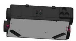
B) Conecte una de las salidas del tubo suministrado a la salida de condensados y el otro extremo al sifón, de manera que el sifón quede lo mas vertical posible.
